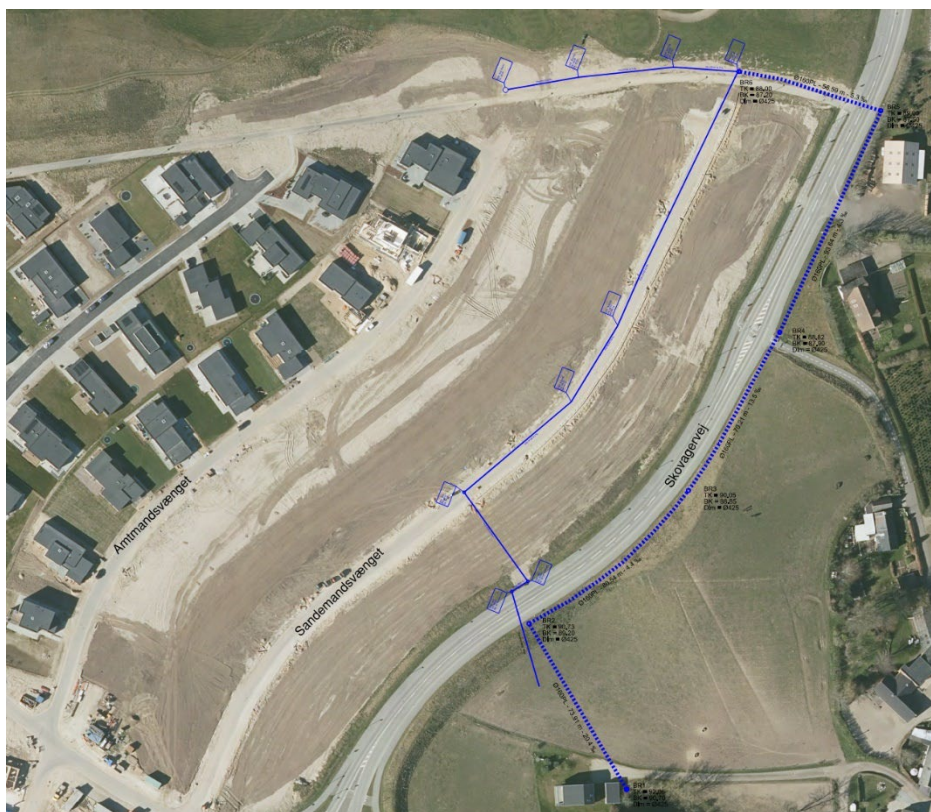
Figur 3 Eksisterende og projekteret forløb af rørlagt vandløb. Det eksisterende forløb af vandløbet er vist som fuldt optrukket blå linje, mens det projekterede forløb er vist som stiplede blå linje. Brøndkoter, fald og rørdimensioner kan aflæses af Bilag 1.
